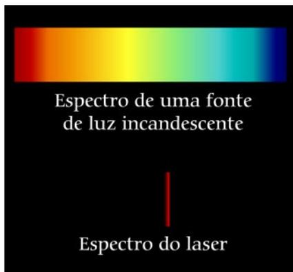
Figura 13. Espectro contínuo (vários comprimentos de onda) e espectro discreto do laser (apenas um comprimento de onda).
